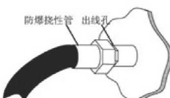
a. 如图，预先为电缆套上防爆挠性管组件；取下压紧螺母后，保留标配的垫圈和胶圈（也可以使用包装箱内的备件）。
